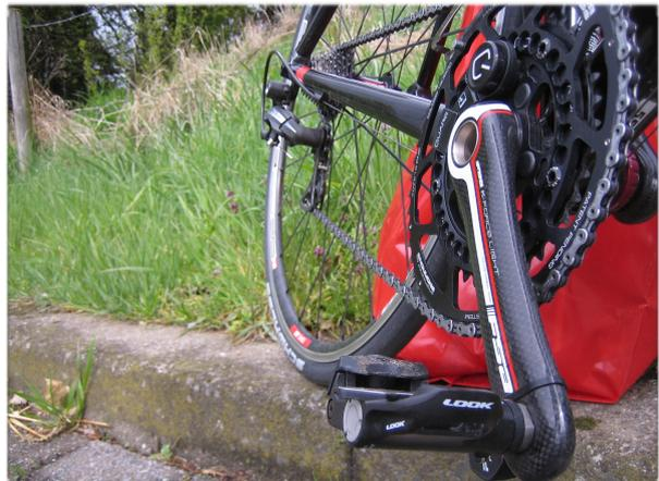
Beim Einbau hat die Ausrichtung der Pedale im Verhältnis zum Kurbelarm maßgeblichen Einfluss auf die Messgenauigkeit, die genaue Ausrichtung ist nicht besonders kompliziert, birgt aber Fehlerpotential bei der Montage. Hier sollte man sich genau an die Einbauanweisung halten und den eigenen Einbau gegebenenfalls überprüfen.
